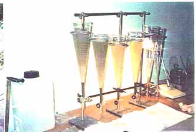
濁度計測中 (「インホフ漏斗」) (左側 2 本 30 分経過, 右側 2 本 1.5 時間経過)
