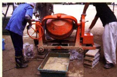
■汚染土壌を水洗浄、放射能大幅に減少
