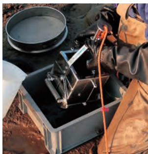
干潮時によるフランス沿岸砂泥底のベントス調査地(左)とEkman-Birgeによる採泥の様子(右) Benthos investigation at low tide in France (left) and mud sampling using Ekman-Birge grab sampler (right)
