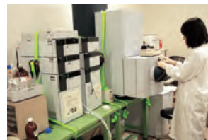
Q-TOF 質量分析装置による生物毒の分析 Analysis of biotoxins using Q-TOF MS
