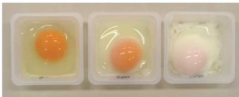
高圧処理を施すと過熱しなくても鶏卵が凝固する
