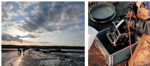
干潮時によるフランス沿岸砂泥底のベントス調査地(左)とEkman-Birgeによる採泥の様子(右) Benthos investigation at low tide in France (left) and mud sampling using Ekman-Birge grab sampler (right)
