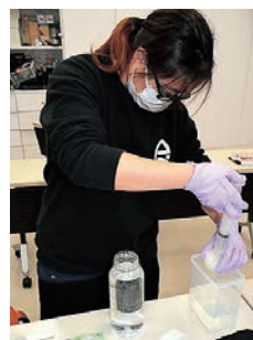
図1 コース在学生在が、eDNA (環境DNA) 分析のために環境から採取した海水を濾過している。(場所:加茂水族館) Fig 1. A student filters water for eDNA (environmental DNA) analysis. (Location: Kamo Aquarium)
