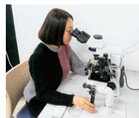
マイクロマニピュレーターを使用した酵母の四分子解析 Yeast tetrad analysis using a micromanipulator
