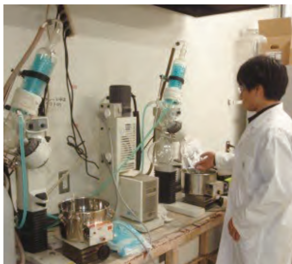
生理活性物質の精製過程では、減圧濃縮や各種クロマトグラフィーを用いる。
