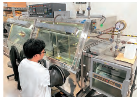
嫌気チャンバーによる嫌気性細菌の培養 Anaerobic chamber for cultivation of anaerobic bacteria
